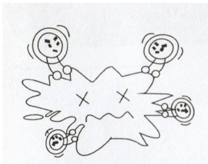
Como onda ultrasónica a través de la solución en el tanque, causa presiones altas y bajas alternas en la solución.
