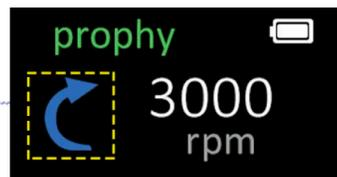
Mantén presionado el botón "S" para cambiar entre la rotación hacia adelante y la rotación inversa.
