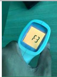
20. Presione la tecla +/- para ajustar el valor de advertencia, el rango de ajuste es + -3.0 °. Después del ajuste, la temperatura del cuerpo humano aumenta o disminuye al valor de temperatura establecido en función de la medición de temperatura original. Esta función se utiliza para circunstancias especiales del Termómetro, generalmente utilizado para pruebas de ingeniería.
