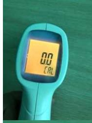
21. Presione la tecla +/- para ajustar el valor de advertencia, el rango de ajuste es + -3.0 °. Después del ajuste, la temperatura del cuerpo humano aumenta o disminuye al valor de temperatura establecido en función de la medición de temperatura original. Esta función se utiliza para circunstancias especiales del Termómetro, generalmente utilizado para pruebas de ingeniería.
