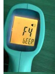
24. Presione la tecla +/- para encender o apagar el volumen. El ícono de volumen se mostrará en la pantalla, mostrando que está encendido y no mostrando que la tecla de volumen está apagada.
