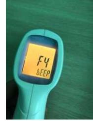
25. En todo el proceso F1 ~ F4 anterior, presione el botón de escaneo para salir inmediatamente, mostrar SAVE por un segundo, indicando el guardado automático y regresar a la interfaz de prueba normal, puede usarlo normalmente.
