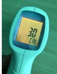
22. Presione la tecla +/- para ajustar el valor de advertencia, el rango de ajuste es + -3.0 °. Después del ajuste, la temperatura del cuerpo humano aumenta o disminuye al valor de temperatura establecido en función de la medición de temperatura original. Esta función se utiliza para circunstancias especiales del Termómetro, generalmente utilizado para pruebas de ingeniería.
