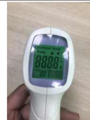
5. Cuando el modo de prueba "Surface" se cambia a temperatura corporal, la palabra "Body" se mostrará en la parte superior de la pantalla, lo que indica que al cambiar el modo de prueba puede comenzar la medición de la temperatura corporal.
