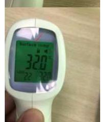
9. Levante el Termómetro en dirección de la frente, apunte la sonda a una distancia de 3-5 cm del centro del objeto, presione el botón de medición, la medición se completa en un segundo y suena un pitido, guárdelo en el registro de la esquina inferior derecha y almacene hasta 32 registros de temperatura a la vez.
