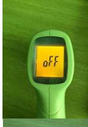
15. Mantenga presionado el botón Configuración durante 3 segundos para ingresar a la interfaz de configuración, la interfaz F1 cambia entre grados Celsius y Fahrenheit, presione la tecla +/- para cambiar entre grados Celsius y grados Fahrenheit.
