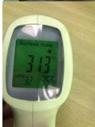
12. Los 32 datos en los dos modos no interfieren entre sí, puede verificarlos de un lado a otro cambiando el botón de modo, una máquina puede almacenar 64 datos de medición de temperatura al mismo tiempo.
