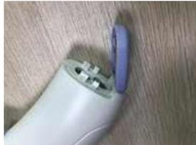
2. Inserte dos pilas tipo AAA de acuerdo con las direcciones positiva y negativa de la carcasa del cuerpo.
