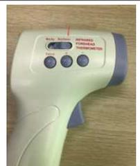
8. En la parte superior de la pantalla se mostrará en consecuencia: "Surface temp" lo cual indica que el modo de medición de temperatura se ha cambiado correctamente y que se puede iniciar la medición de temperatura de la superficie del objeto medido.
