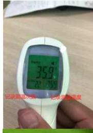
14. El Termómetro se apagará automáticamente después de dejarlo sin usar durante 30 segundos.
