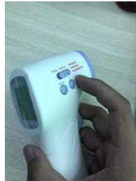
11. Después de marcar el modo de cambio del Termómetro del modo de "Body" a "Surface", se mostrarán 32 datos de temperatura medidos por la temperatura del objeto, presione la tecla +/- para ver uno por uno.
