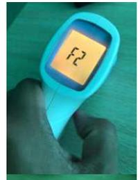
17. El valor de advertencia predeterminado es 38 °. Cuando la temperatura del cuerpo humano probado excede los 38 ° ~ 42 °, la Pantalla del Termómetro se volverá roja y mostrará la temperatura correspondiente.
