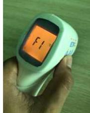
16. Presione el botón Configurar nuevamente (presione brevemente) para ingresar a la interfaz de configuración de F2, establezca el valor de advertencia temprana, F2 se muestra brevemente durante un segundo y salta automáticamente a la interfaz de depuración del valor de advertencia temprana.
