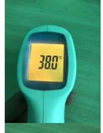
18. Presione la tecla +/- para ajustar el valor de advertencia, el rango de ajuste es 37.1 ° ~ 38.6 °. Después del ajuste, si el cuerpo humano medido está por debajo de la temperatura establecida, no habrá alarma, si es más alto que el valor de temperatura establecido, la pantalla se vuelve roja para mostrar el valor de temperatura y la alarma.
