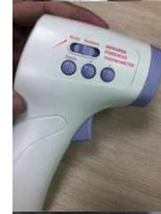
6. Levante el Termómetro hacia la frente, apunte la sonda a una distancia de 3-5cm del centro de la frente, presione el botón de medición, la medición se completa en un segundo y suena un pitido, es guardado en la esquina inferior derecha y se almacenan hasta 32 registros de temperatura a la vez. La medición de temperatura en modo de temperatura corporal fue completada.
