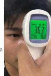
7. Después de encender el Termómetro, cambie al modo del interruptor para toma de temperatura de la frente a "Surface".
