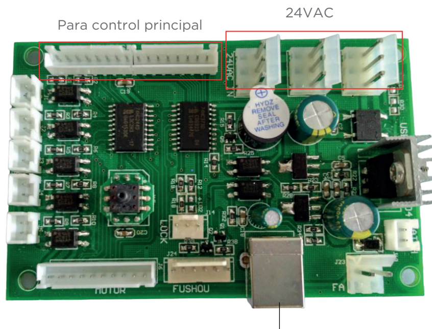
Conexión de cables para la placa del sensor de presión de aire
