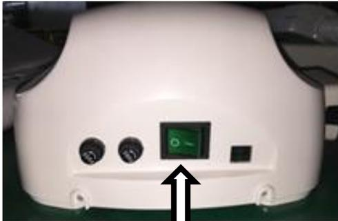
El interruptor de alimentación se encuentra en la parte inferior del mando a distancia. Después de la alimentación de arranque, la luz indicadora del interruptor de encendido brilla, indica que la alimentación está encendida. Todas las luces del panel brillan, la ventana de tiempo 888, para examinar si la superficie de la pantalla es normal o no.
